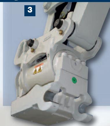
■ **Zuleitungen für Schnellwechsler und Powertilt** – sind abrißsicher auf dem Löffelstiel verlegt
