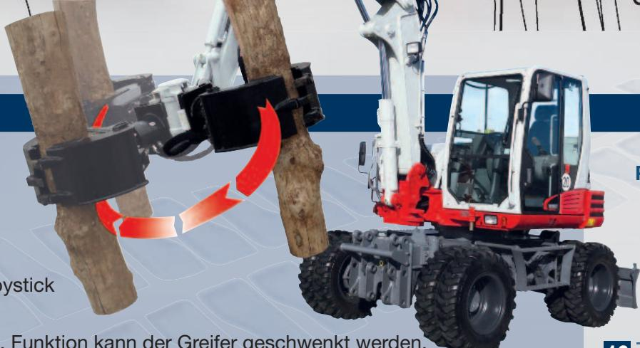
Über den Schieberegler der 3. Funktion kann der Greifer geschwenkt werden.
