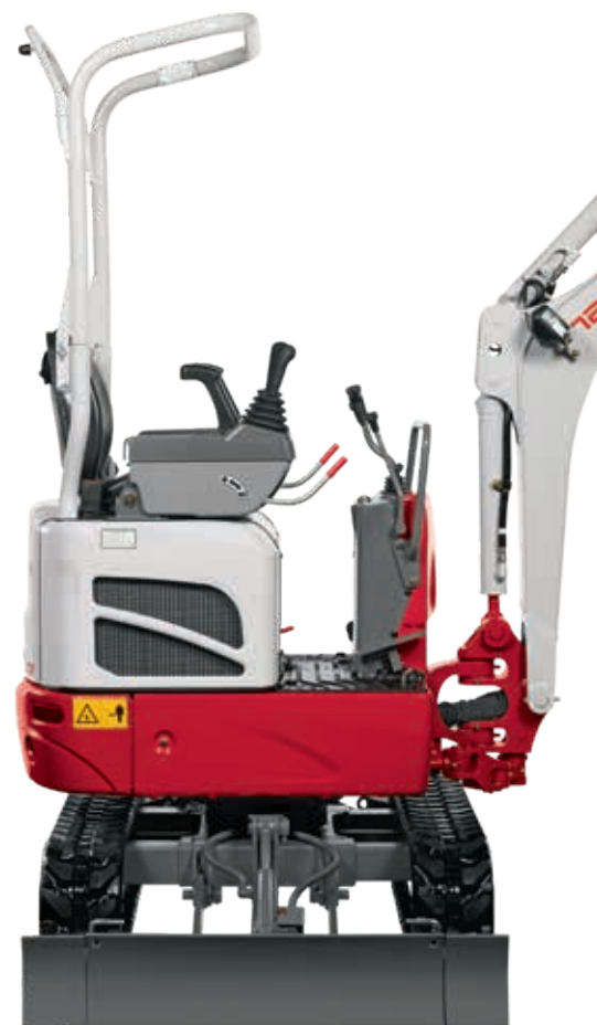
MIN. HECKÜBERSTAND BEI LAUFWERKSBREITE 1.020 MM
