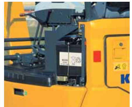
Linke Wartungsklappe: leichter Zugang zur Batterie
